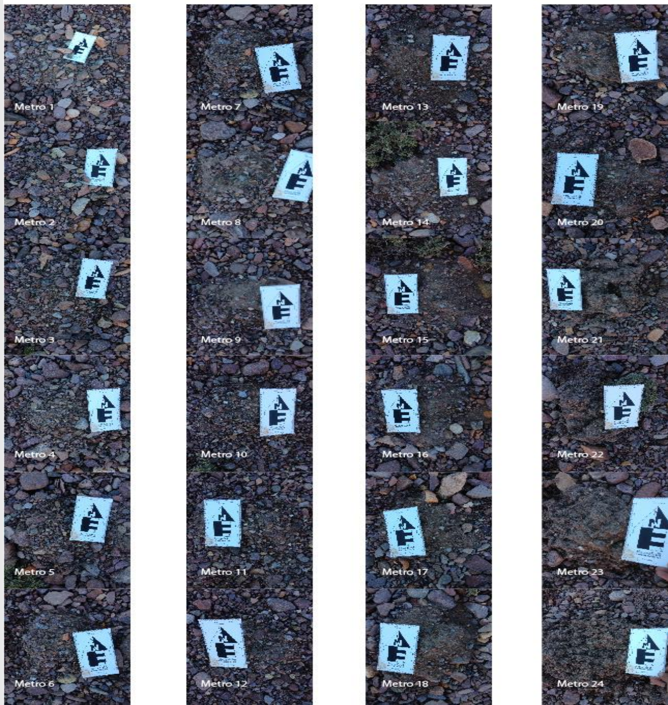
Fotografías por cada metro de "cuttings" de perforación
